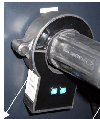
Shunt monterad på minus eller plus polen på svetsmaskinen
